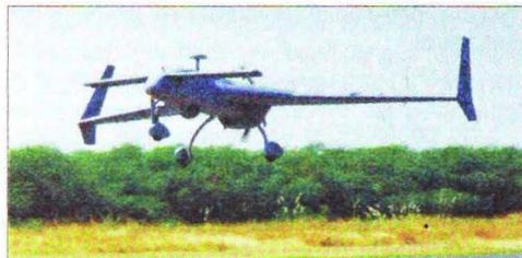
максимальной скорости 150 км/ч. Он способен находиться в воздухе до 7 ч и передавать разведывательную информацию в режиме реального времени. Максимальная взлетная масса аппарата составляет около 470 кг при полезной нагрузке 50 кг. Тактико-технические характеристики БЛА «Буррак» не предавались огласке, однако предполагается, что он оснащается двумя ракетами класса «воздух – поверхность».
