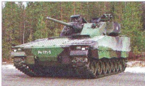
Среди улучшенных характеристик CV-9030 западные военные эксперты отмечают такие, как повышенные броневая защищенность, живучесть на поле боя, ситуационная осведомленность экипажа (благодаря установленным по бортам видеокамерам) и возможности взаимодействия с другими подразделениями. Новые машины оснащаются обрезиненными гусеницами и могут применяться в различных вариантах, в том числе в качестве самоходного миномета и машины тылового обеспечения.
